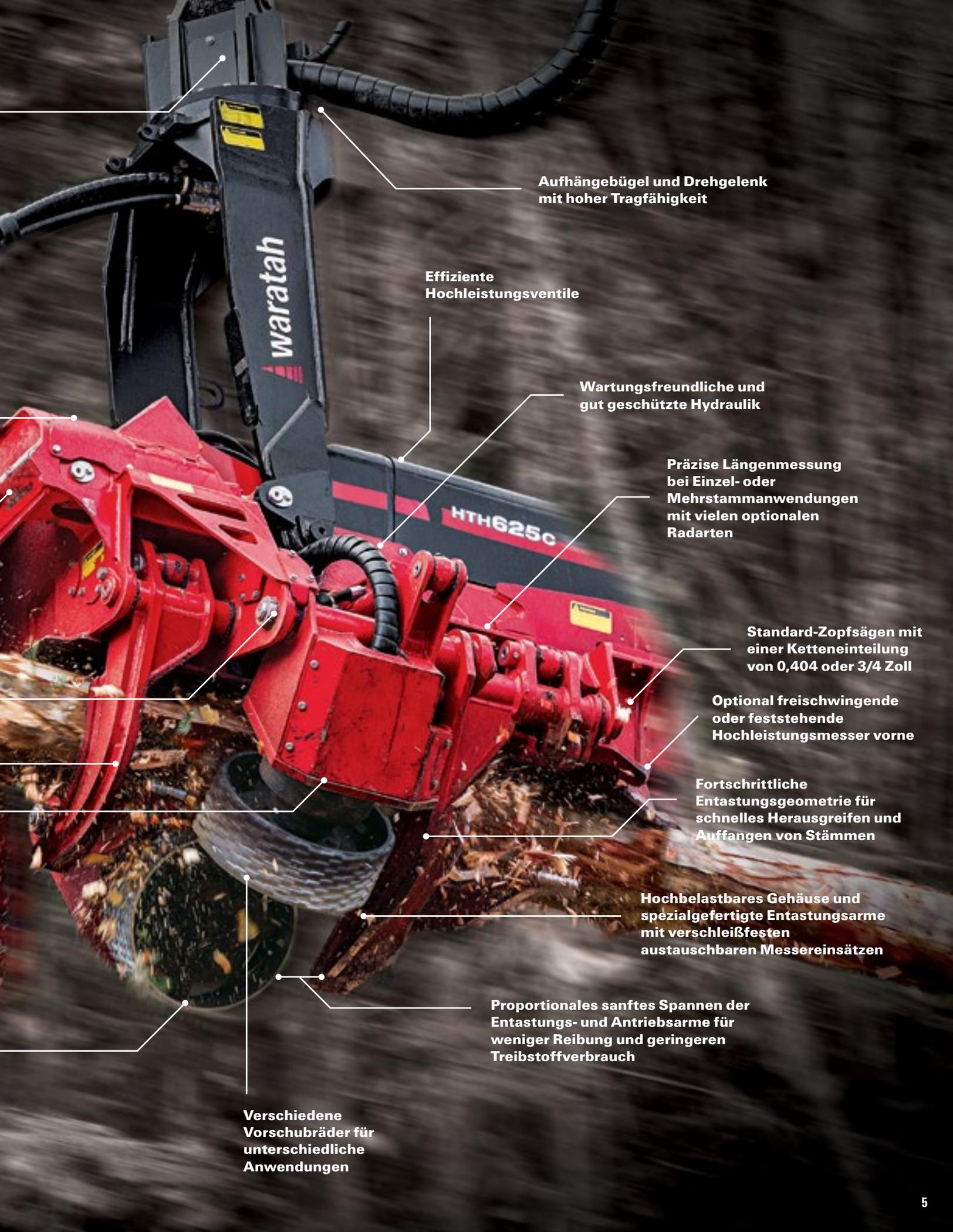
**Aufhängebügel und Drehgelenk mit hoher Tragfähigkeit**
