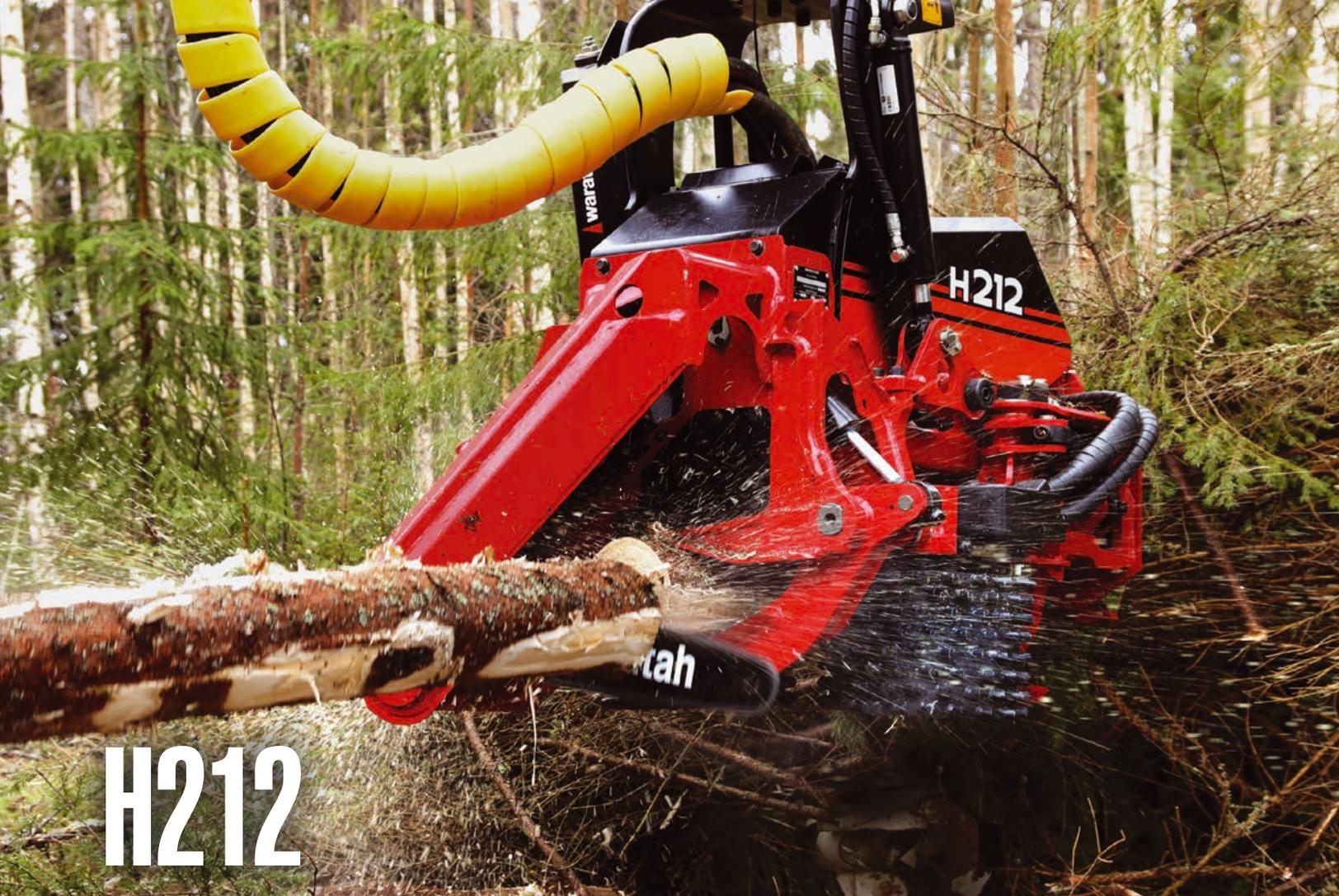
Компактная и маневренная модель H212 отличается превосходной производительностью и высокой скоростью работы при валке, обработке и окорке стволов. Благодаря прочной и подвижной конструкции эту универсальную головку можно смело назвать маленьким гигантом в лесу.
